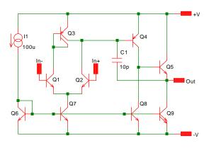
Fig. 8-1: Simple 3-stage op-amp.
