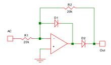
Fig. 16-13: Standard op-amp halfwave rectifier.
