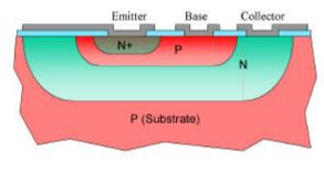
Fig. 1-9: A simple planar NPN transistor.
